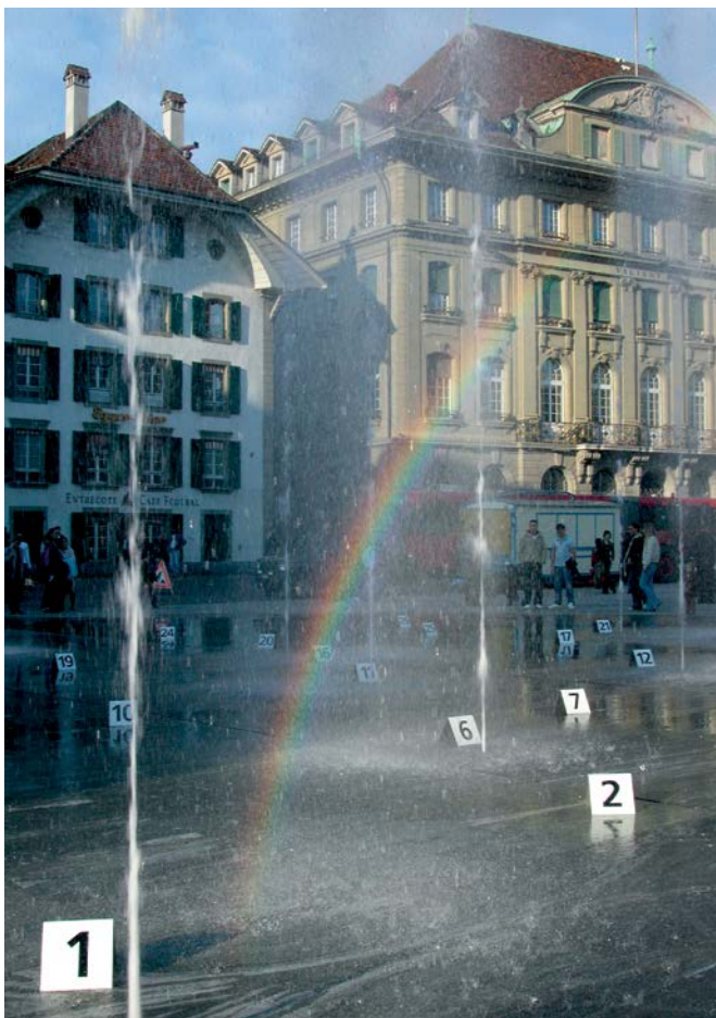
Wasserspiel Bern Bundesplatz: Springbrunnen der anderen Art: Keine Mauer, keine Absenkung, keine Linien, Gitter, Geländer, keine Grenzen zwischen "Brunnen" und Publikum. Zum Proben und Installieren der Choreo bekamen die einzelnen Düsen Nummernschilder, damit die Übersicht beim Choreografieren gewährleistet blieb.
